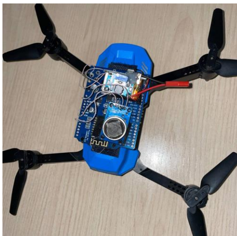
4.8- сурет – Көміртегі оксиді газының концентрациясын қашықтан анықтайтын аспап
