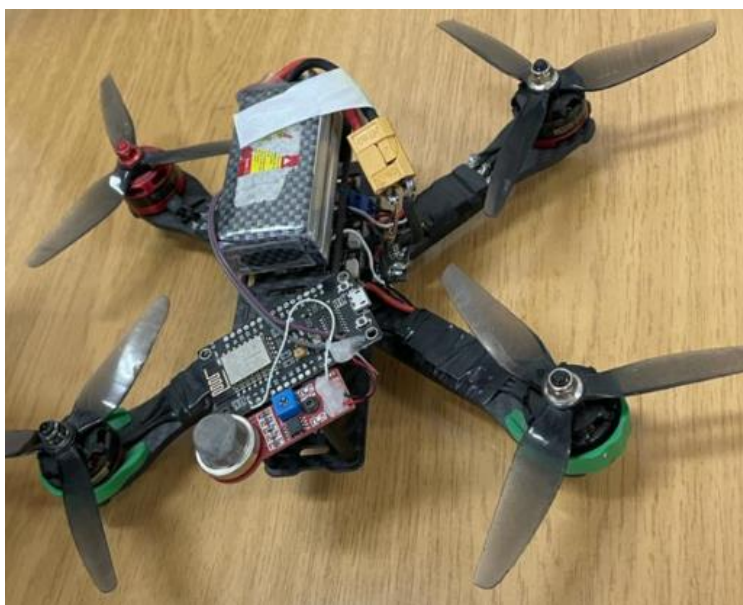
3.1 - сурет – Зиянды газдардың концентрациясын анықтайтын аспап
