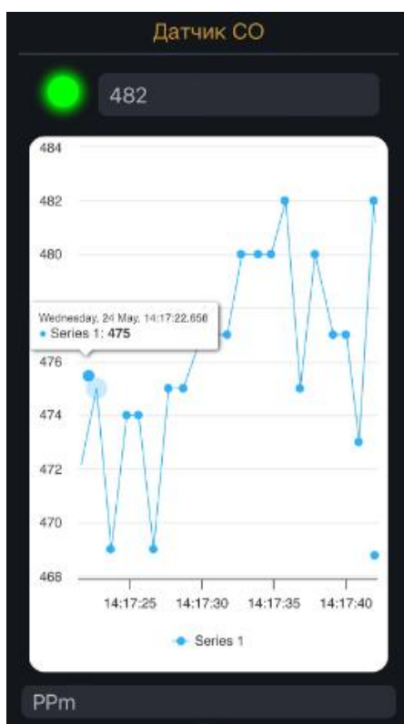
4.11 - сурет – Газ концентрациясының смартфон арқылы бақылау графигі
